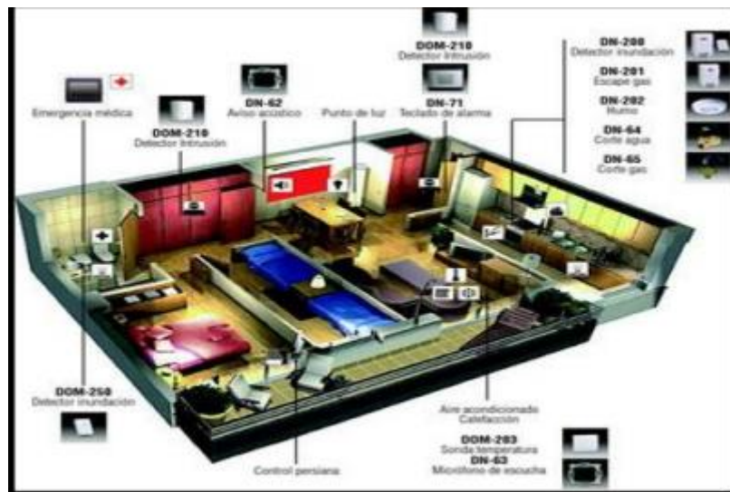
Ilustración 15 Mandos Domóticos. Fuente: Casa del Intercomunicador. Elaborado por: Molina. K, 2019
