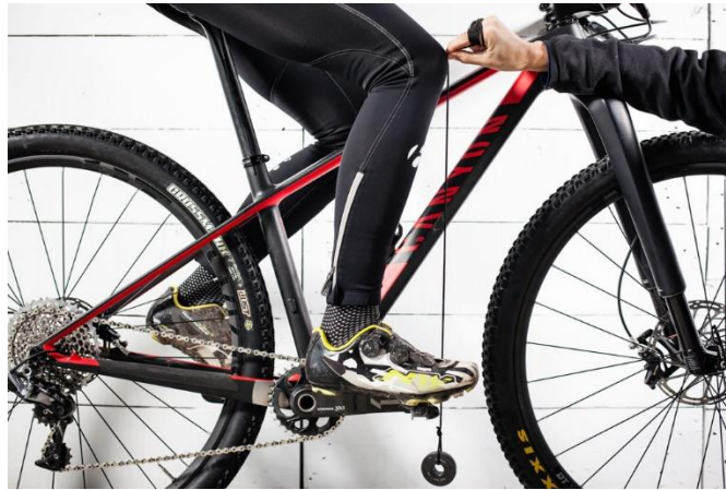
Figura 3: El retroceso del sillín hará coincidir la vertical de rótula y eje del pedal.
