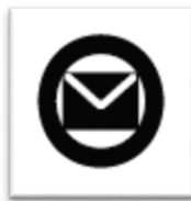
Imagen 31. Eventos se enviará un mensaje a otro proceso con el final de este flujo
