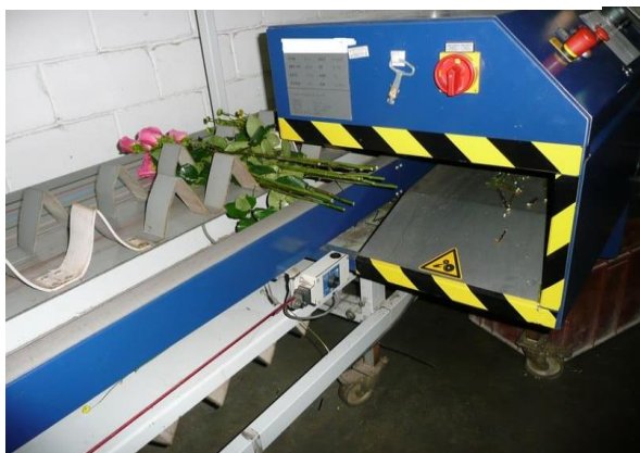
Figura 6 Cortadora de tallos
